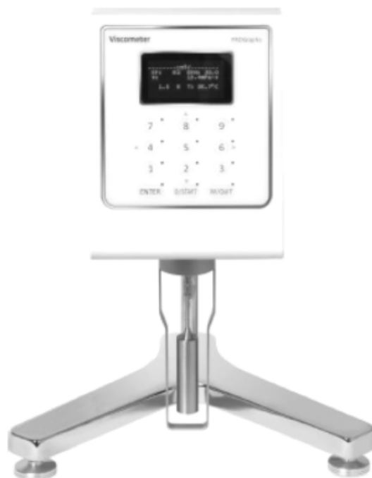
图 2 L 型单筒式旋转黏度计示例
